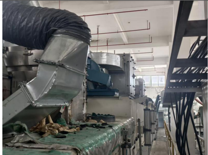
涂布机（左图为底部放卷涂布区、右图为顶部烘道）
