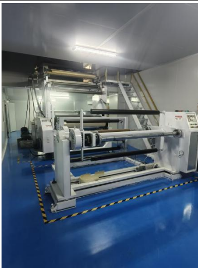
涂布机（左图为底部放卷涂布区、右图为顶部烘道）
