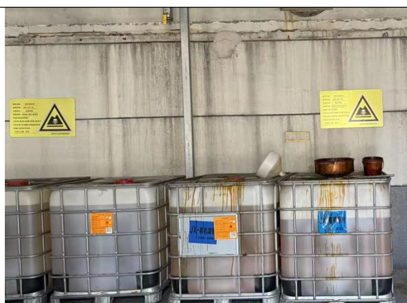
内部分区警示标识牌、危废标签
